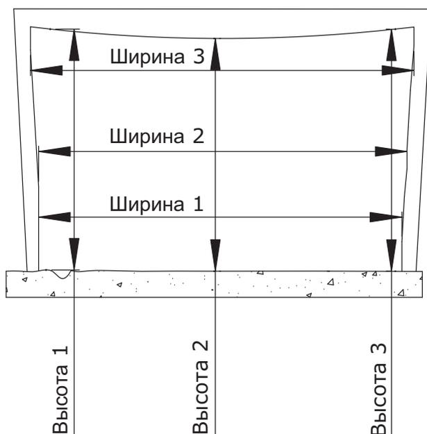
Проверить вертикальность стен относительно уточненной горизонтали.
