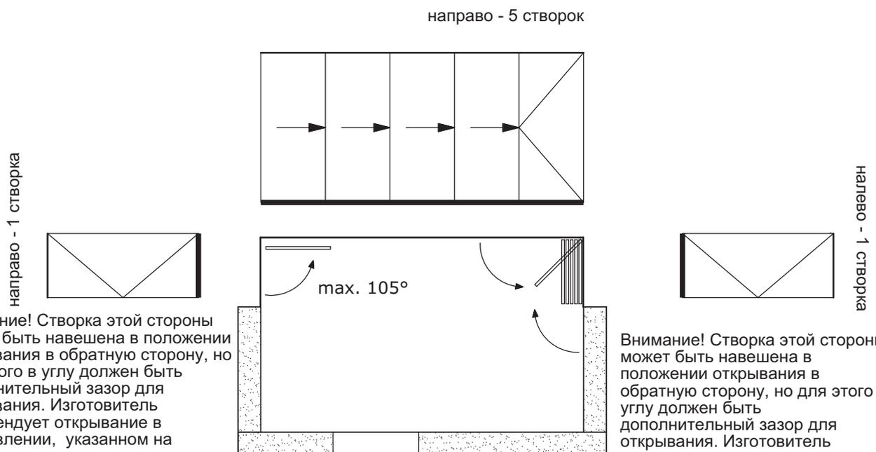
**Внимание!** Створка этой стороны может быть навешена в положении открывания в обратную сторону, но для этого в углу должен быть дополнительный зазор для открывания. Изготовитель рекомендует открывание в направлении, указанном на чертеже.
