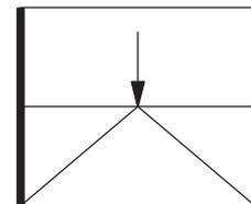
В месте препятствия устанавливают глухое стекло. Там, где нет возможности передвигать створки через угол и препятствия, или же невозможно переместить точку крепления петли из-за внешнего препятствия, у препятствия устанавливается глухое стекло.
