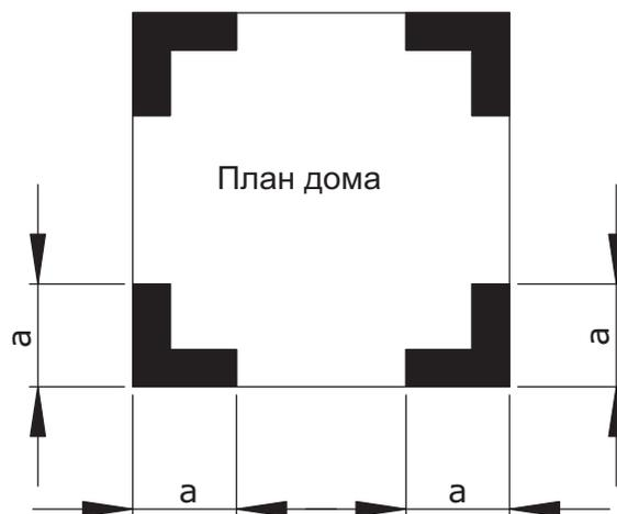
Все расчеты должны быть согласованы с местными строительными нормами. На схеме показатель  $a$  (м) составляет 10% от наибольшего значения по горизонтали ( $b_1$  или  $b_2$ ) или  $0,4 h$ . Выбирается наименьшее значение.
