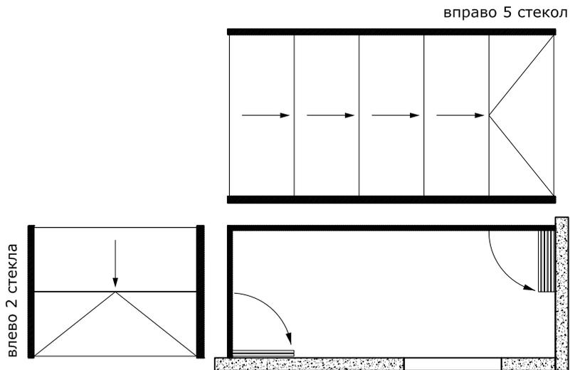
Балкон Г-образной формы, открываемый в одну сторону, стекла сдвигаются через угол.
