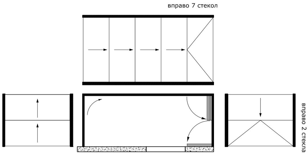
четырёхсторонний балкон, открываемый на две стороны, стекла которого перемещаются через угол в 135 градусов.
