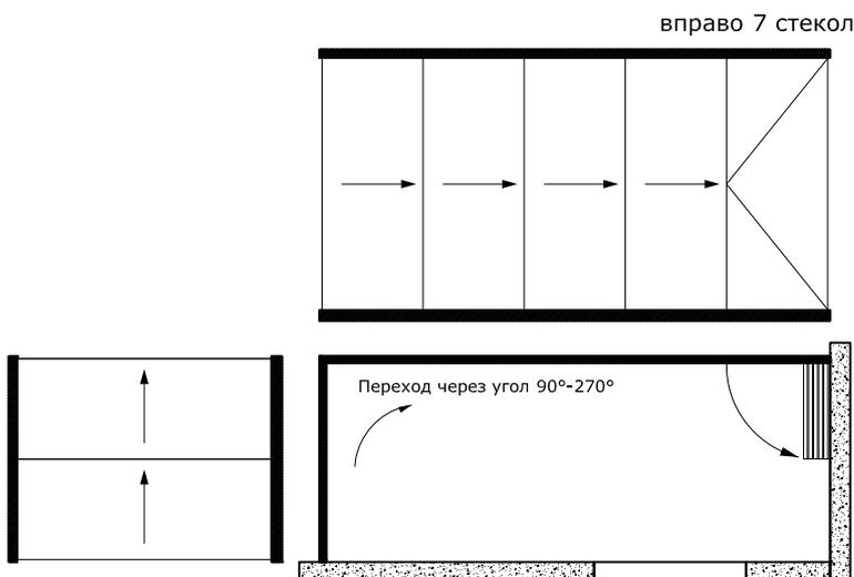
**Балконы, на которых имеется препятствие, например, водосточная труба или колонна.**
