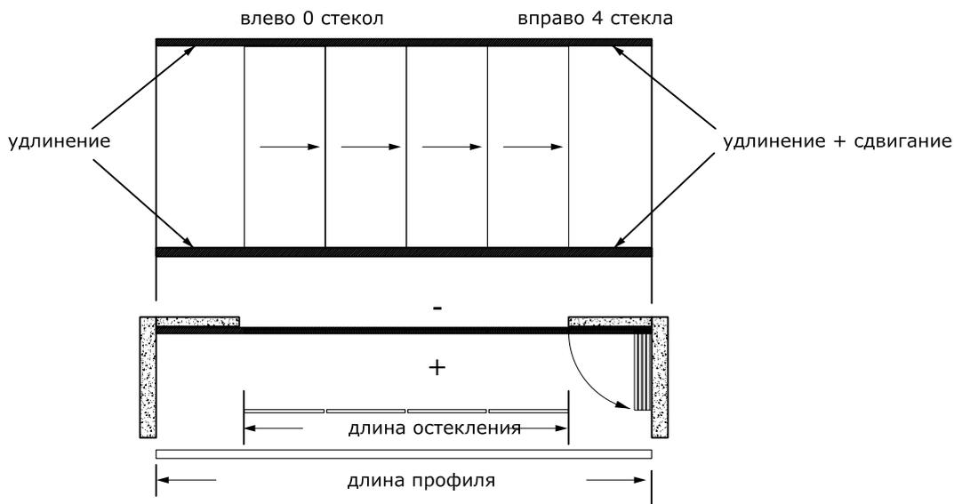
Остекление заканчивается неподвижным элементом, но открывается только у конца профиля. Удлинение профиля должно составлять не менее 40 мм. В этом случае на первое стекло нельзя устанавливать защелки.
